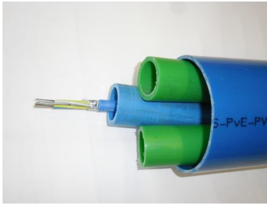
Figuur 5.14: Voorbeeld van een type mantelbuis met daarin weer een aantal mantelbuizen (hdpe-buizen), waarvan één met een telecomkabel. Het model maakt verwijzingen tussen mantelbuizen en kabels mogelijk.
